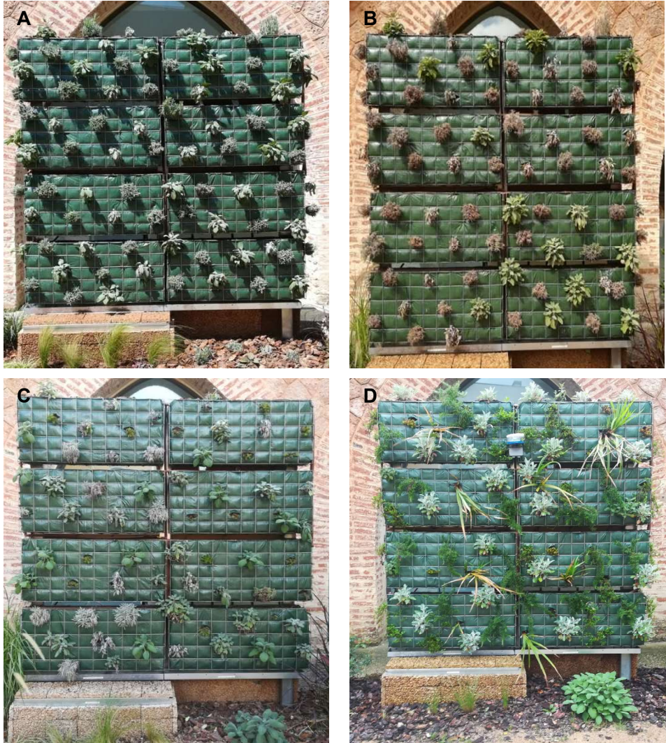
Figura 2 Prototipo piloto de pared verde autoportante con gaviones Babylon® con sustrato de corcho. (a) en julio 2019; (b) en septiembre de 2019; (c) en diciembre de 2019 y (d) en abril de 2020, con: Rosmarinus prostratus , Lippia nodiflora , Cineraria sp. Carex sp.
